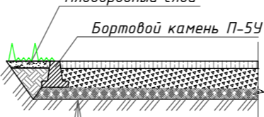
КОНСТРУКЦИЯ ПОКРЫТИЯ ТРОТУАРОВ НОВОЕ
